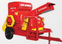
Elemeli Savurmalı Kombine Harman Makinesi
